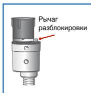
Для отворачивания шланга системы Aquastop (при наличии) следует отжать и удерживать рычаг разблокировки (при наличии).
