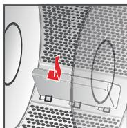
5. Проверните барабан на полоборота. Выньте посторонний предмет через отверстие в барабане.
