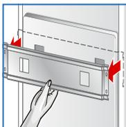
2. Снимите транспортировочный фиксатор.
